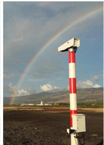
Les valeurs du PTA et donc de la POM sont déterminées par la mesure de l'atténuation du signal d'une source de lumière blanche de type LED modulée à 30 Hz, à travers la couche de l'atmosphère comprise entre l'émetteur et le récepteur.
